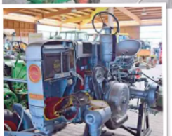
Dieser aufgeschnittene Lanz D 1706 erlaubt Einblicke in sein Innenleben
